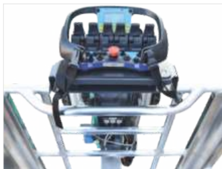
Panou de control ușor de utilizat cu suport extern la coș. Mai mult spațiu disponibil în coș.
