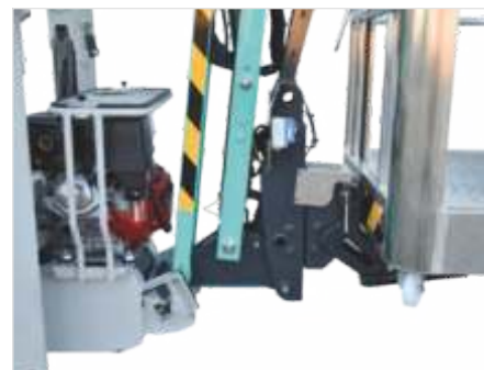
Compactitatea ansamblului braț care găzduiește celula de sarcină și sistemul de montare rapidă a coșului.
